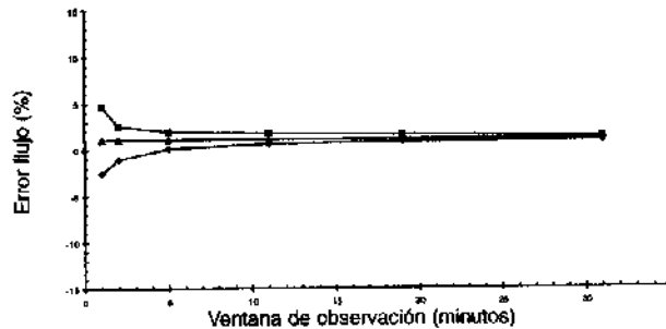
Gráfica de trompeta a 25,0ml/h (tras 24 Horas) Sistema IV ASENSA GW 273-001
